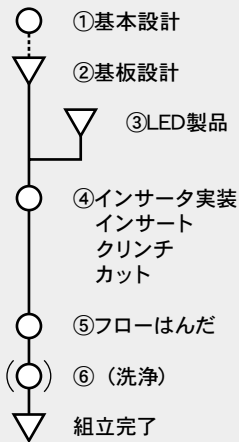
縦型LEDランプ標準実装フロー (フローはんだ付け)
